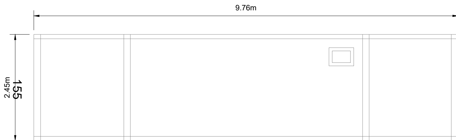
'Mobile mini 32ft x 10ft Toilet Block' Unit Rear Elevation
